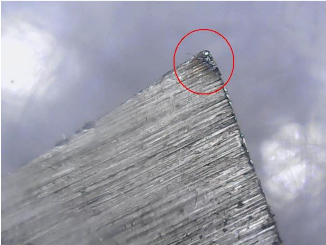
Gambar L. 9: Keausan pahat pada putaran spindel 600 rpm
