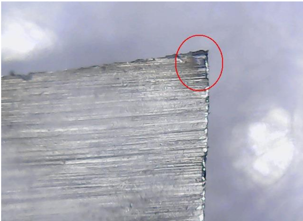
Gambar L. 8: Keausan pahat pada putaran spindel 400 rpm
