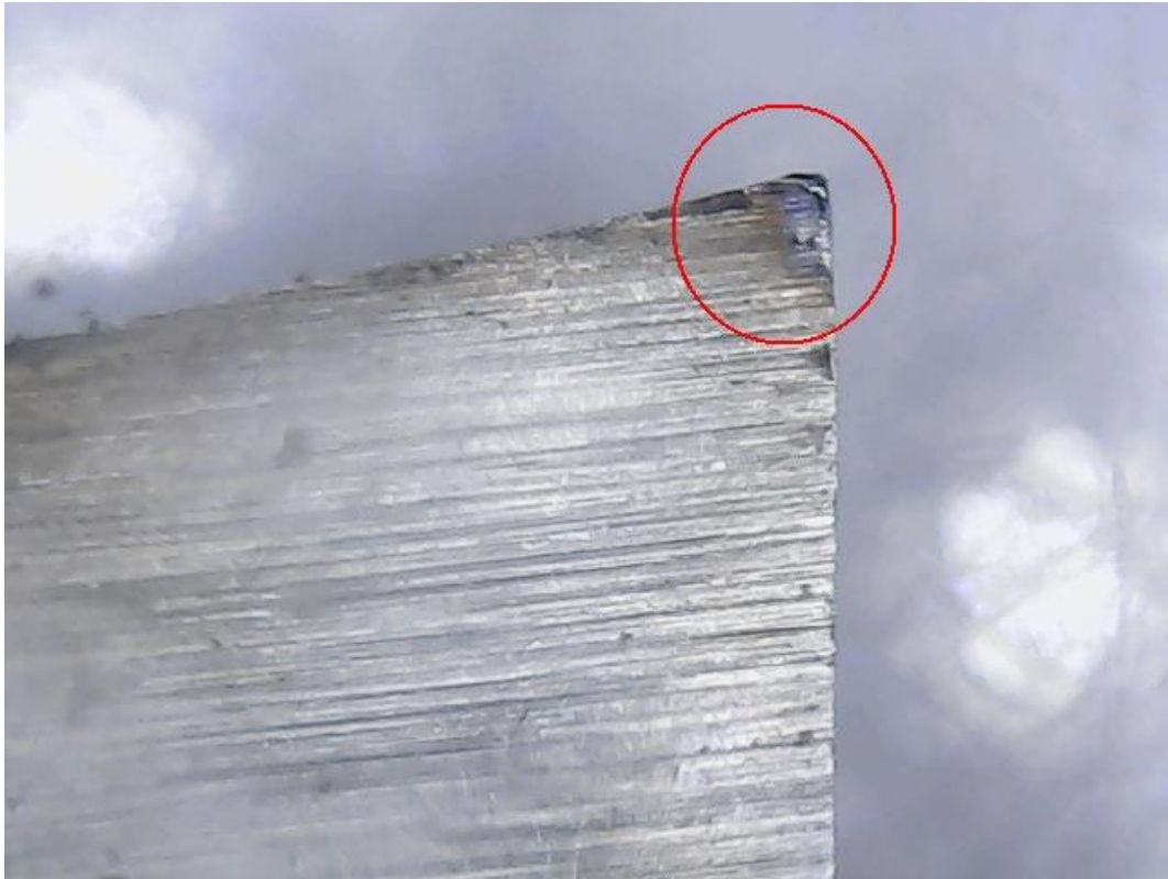
Gambar L. 7: Keausan pahat pada gerak makan 0,8 mm/put
