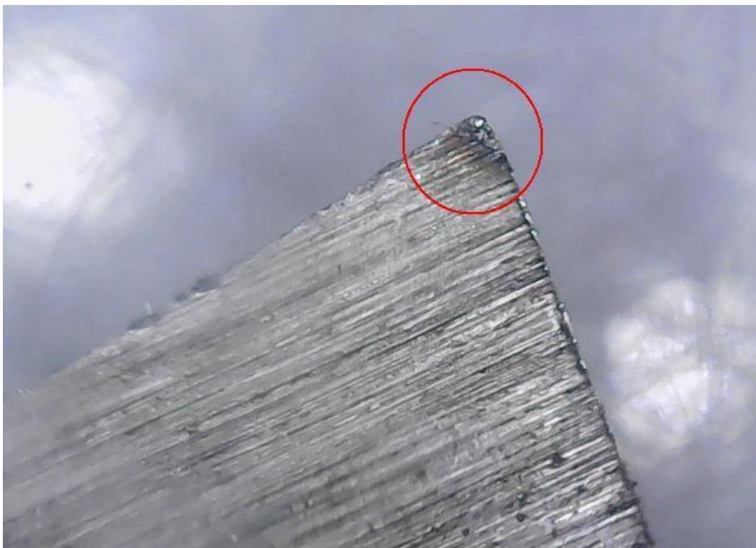
Gambar L. 6: Keausan pahat pada gerak makan 0,6 mm/put
