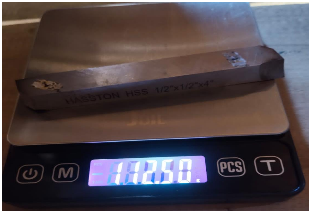
Gambar L. 10: Berat pahat spesimen 1 sebelum dilakukan pembubutan.
