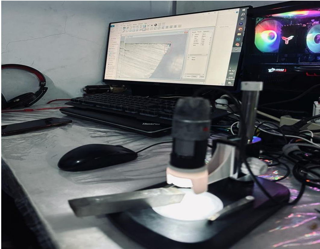
Gambar L. 5: Pengamatan keausan pahat dengan mikroskop
