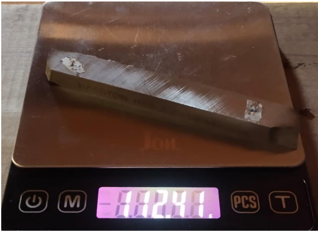
Gambar L. 11: Berat pahat spesimen 1 setelah dilakukan pembubutan.
