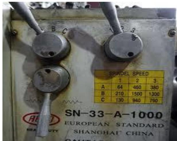
Gambar 2. 14 Pengaturan kecepatan putaran spindle
