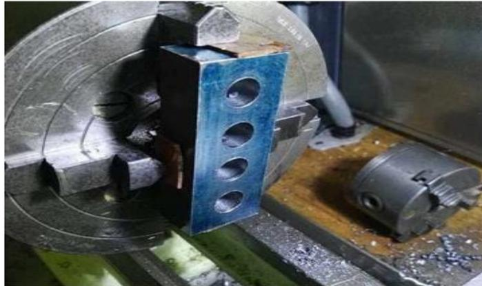
Gambar 2. 7 Alat pengecam mesin bubut
