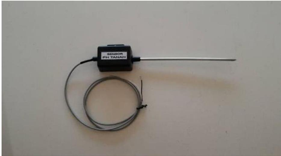
Gambar 2. 2 Sensor pH Tanah
