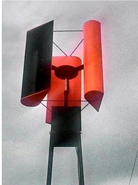
Gambar 2. 2 Model kincir angin sumbu vertikal jenis Lenz2 setelah di rakit
