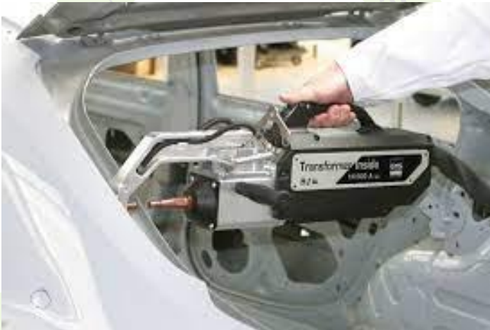
Gambar 4.2 pengelasan bodi kendaraan dengan las titik
