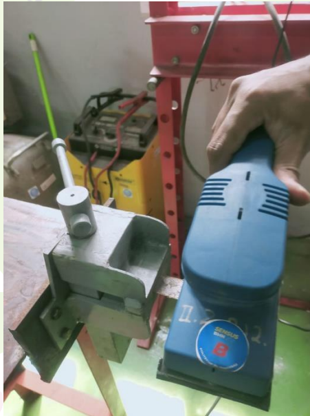
Gambar 2.3 proses persiapan material dengan pengamplasan pada permukaan material.
