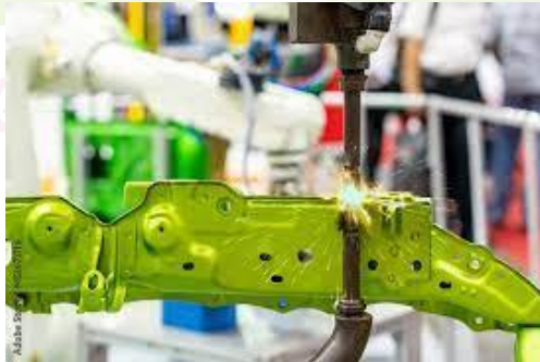
Gambar 4.1 pengelasan rangka kendaraan dengan las titik
