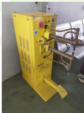
Gambar 2.1 ; Las titik dengan sistem tekanan menggunakan pedal kaki
