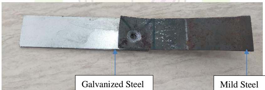
Gambar 3.1 Dissimilar galvanized steel dengan mild steel
