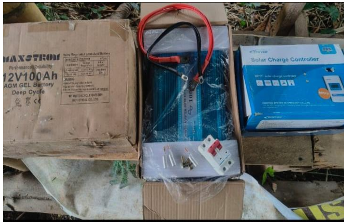
Baterai, inverter, dan SCC tipe MPPT
