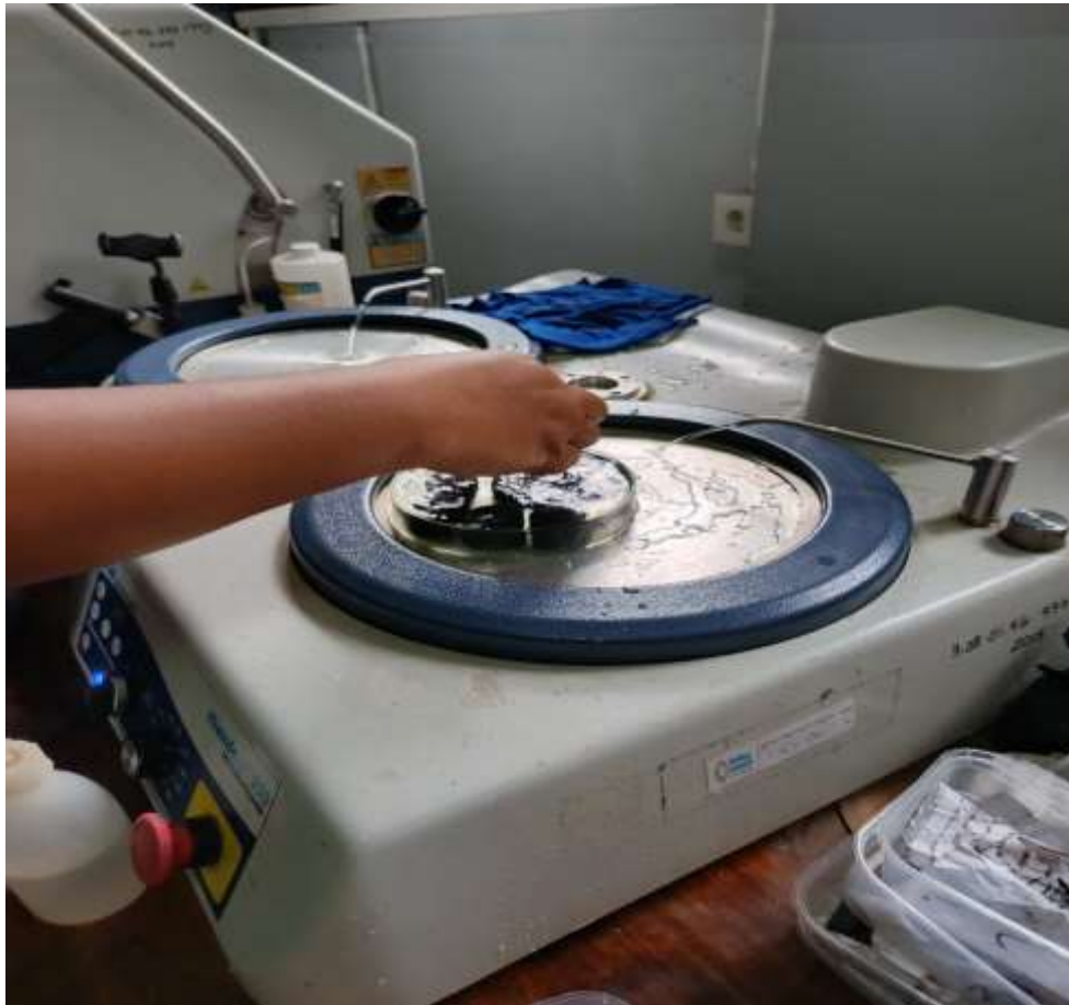
Gambar 11. Proses pengamplasan spesimen struktur mikro
