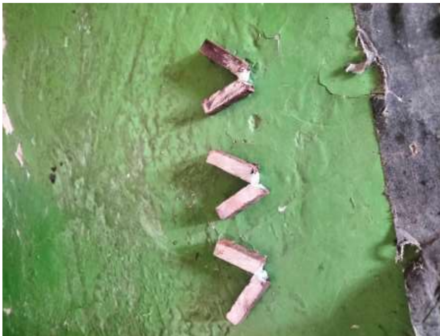
Gambar 6. Pebgujian Impact pada spesimen arus 90 Ampere
