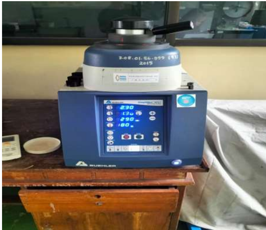
Gambar 9. Proses pembuatan cetakan pada struktur mikro
