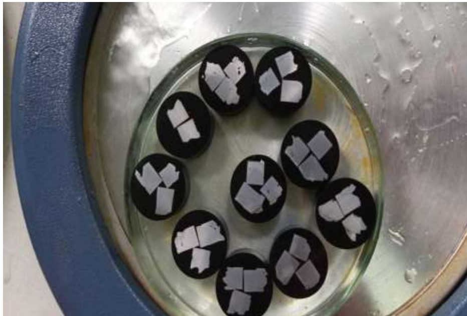
Gambar 10. Proses spesimen struktur mikro setelah di cetak
