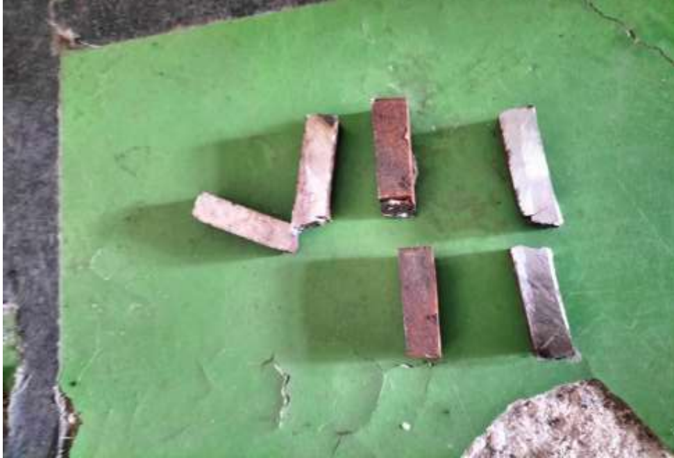
Gambar 7. Pebgujian Impact pada spesimen arus 100 Ampere
