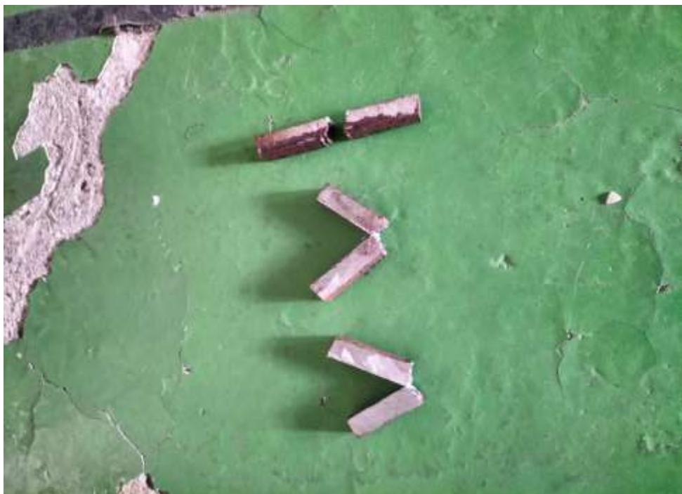
Gambar 8. Pebgujian Impact pada spesimen arus 110 Ampere
