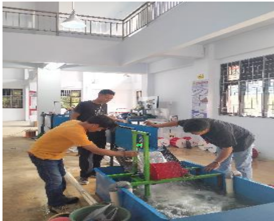
Gambar L.21 Pemasangan sudu pada kincir air
