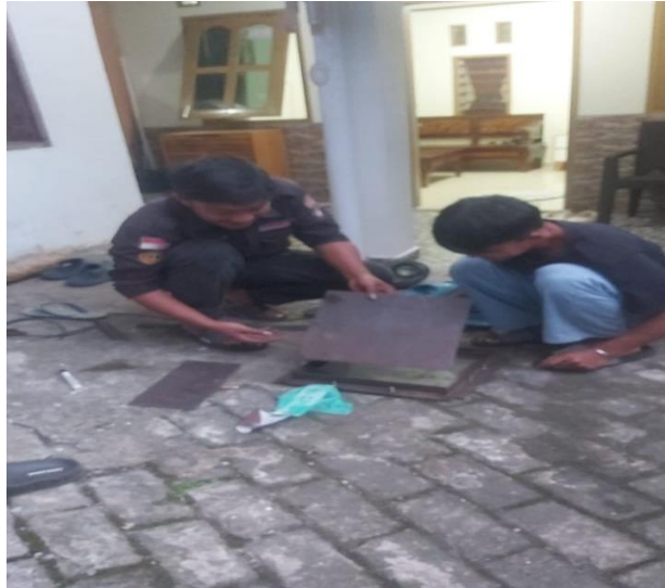
Gambar L4. Proses pembuatan cetakan spesimen
