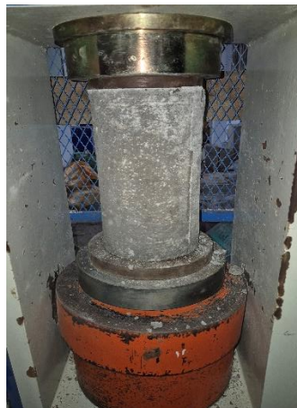
Pengujian kuat tekan beton
