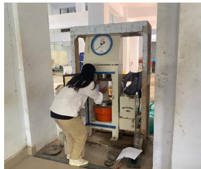
Pengujian kuat tekan beton
