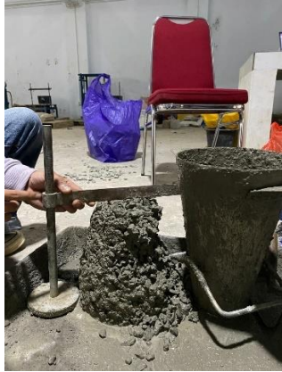
Slump Beton Kontrol
