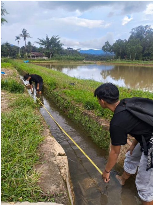
Pengukuran Kecepatan Aliran Pada Saluran
