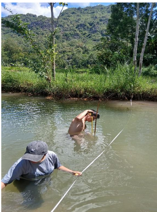
Pengukuran Lebar dan Kedalaman Sungai
