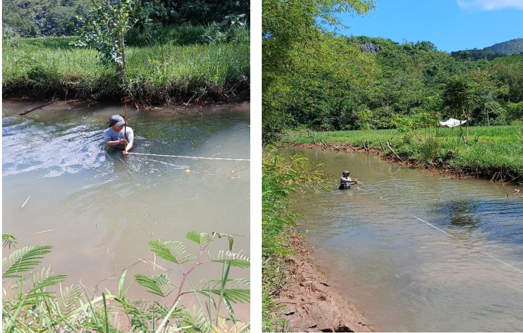
Pengukuran Kecepatan Aliran Sungai Menggunakan Pelampung
