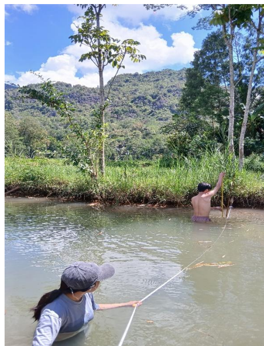
Pengukuran Lebar dan Kedalaman Sungai
