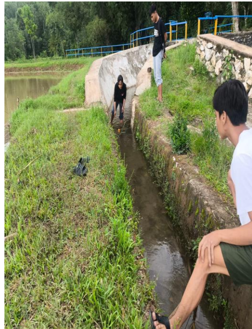
Pengukuran Kecepatan Aliran Pada Saluran
