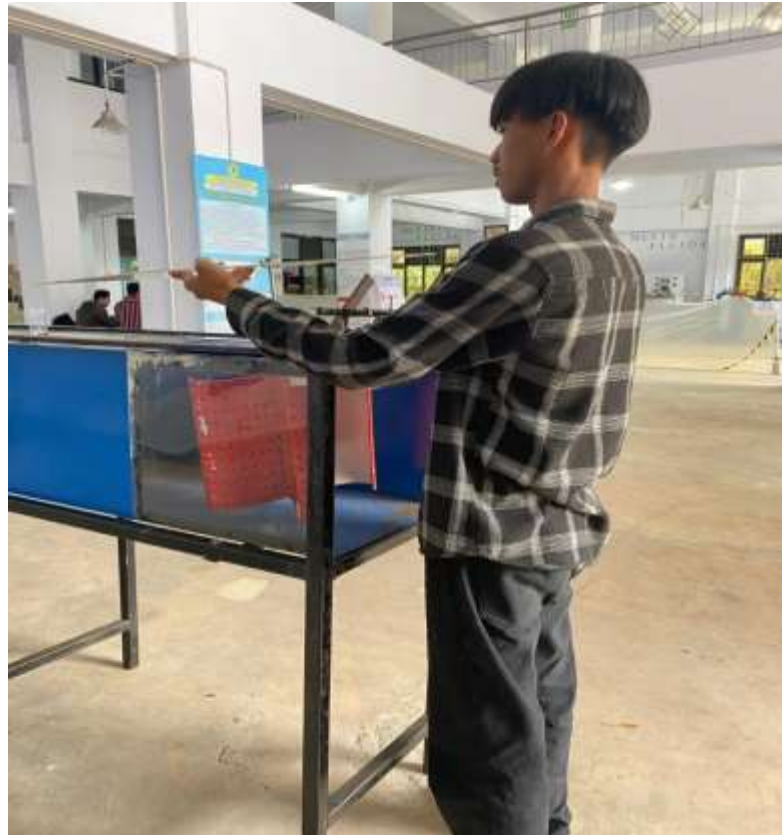
Gambar L.11 Proses pemasangan rotor pada wind tunnel
