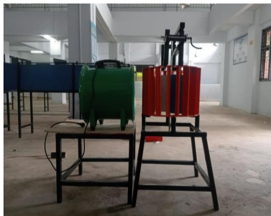
Gambar L. 34 Turbin Angin Savonius Dua Sudu Variasi jumlah Dimple
