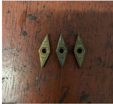
Gambar 2.8 Insert pahat karbida tungsten kobalt 6% Sumber : (Dokumentasi 2025)
