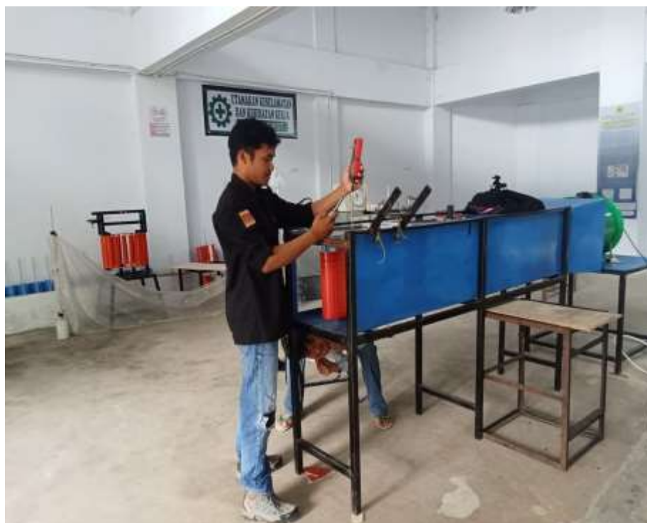
Gambar L. 2 Proses pengukuran putaran dengan tachometer
