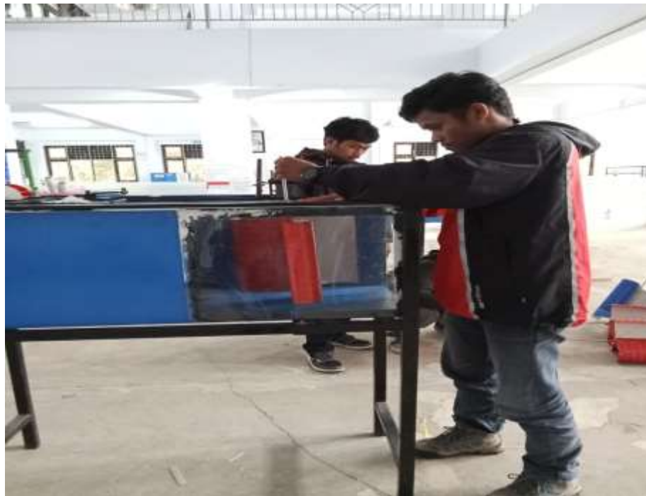
Gambar L.1 Proses pemasangan rotor pada wind tunnel
