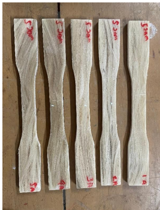
1.14 pesimen uji tarik perendaman 4 jam
