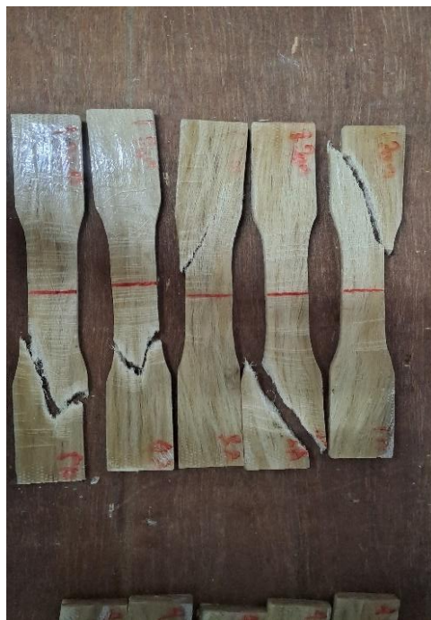
1.17 spesimen sesudah uji tarik lama perendaman 1 jam
