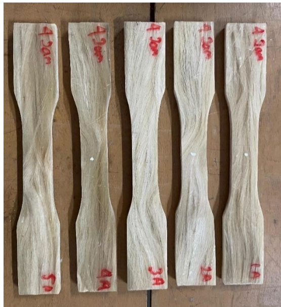
1.14 pesimen uji tarik perendaman 4 jam
