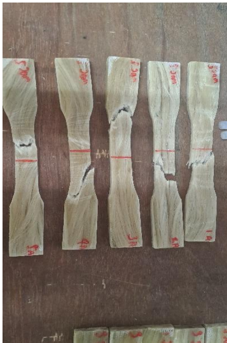
1.21 spesimen sesudah uji tarik lama perendaman 5 jam
