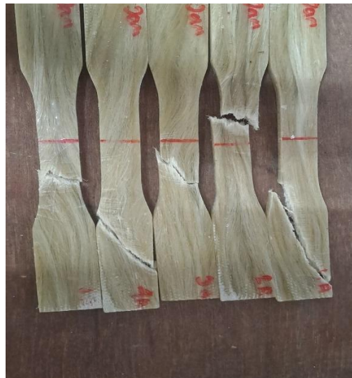
1.19 spesimen sesudah uji tarik lama perendaman 3 jam
