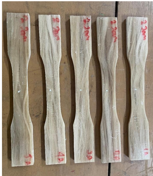
1.12 spesimen uji tarik perendaman 2 jam
