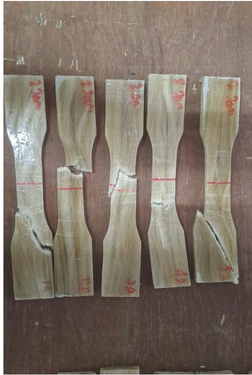
1.18 spesimen sesudah uji tarik lama perendaman 2 jam
