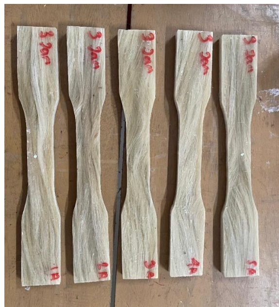
1.13 pesimen uji tarik perendaman 3 jam
