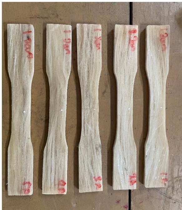
1.11 Spesimen uji tarik perendaman 1jam
