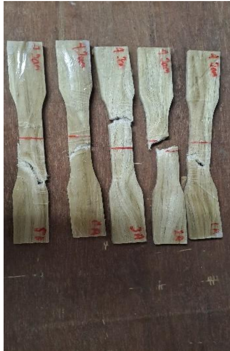
1.20 spesimen sesudah uji tarik lama perendaman 4 jam
