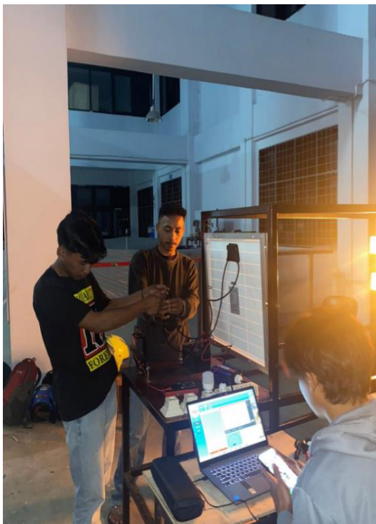
Gambar L-2.2 Pengambilan data I_{sc} , V_{mp} dan I_{mp} 225v, 200v, 175v, 150v, 125v, 100v, dan 75v
