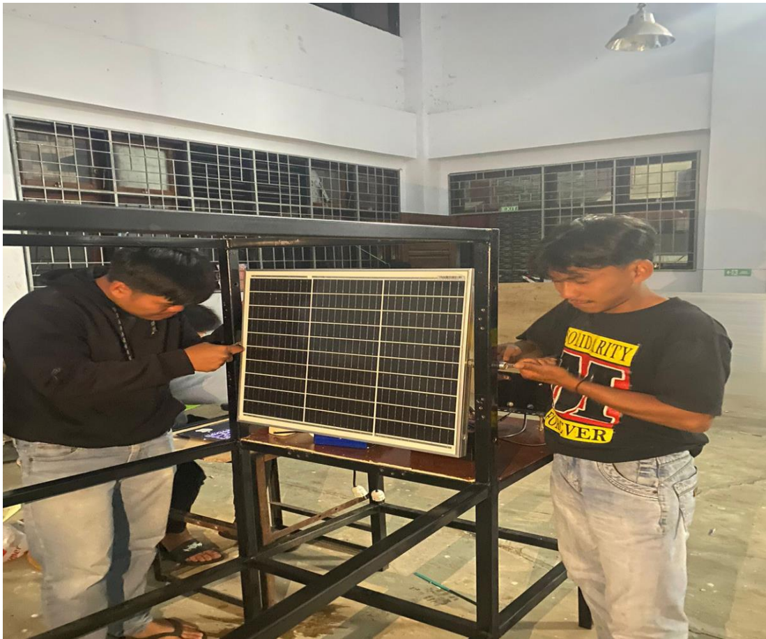
Gambar L-1.1 Pemasangan solar cell
