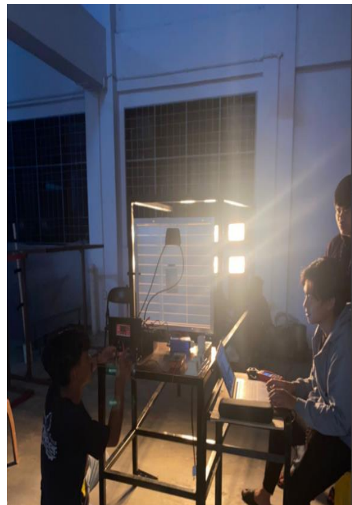
Gambar L-2.2 Pengambilan data I_{sc} , V_{mp} dan I_{mp} 225v, 200v, 175v, 150v, 125v, 100v, dan 75v
