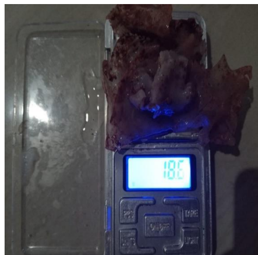
Gambar L.14 Berat akhir pengujian biodegradasi
