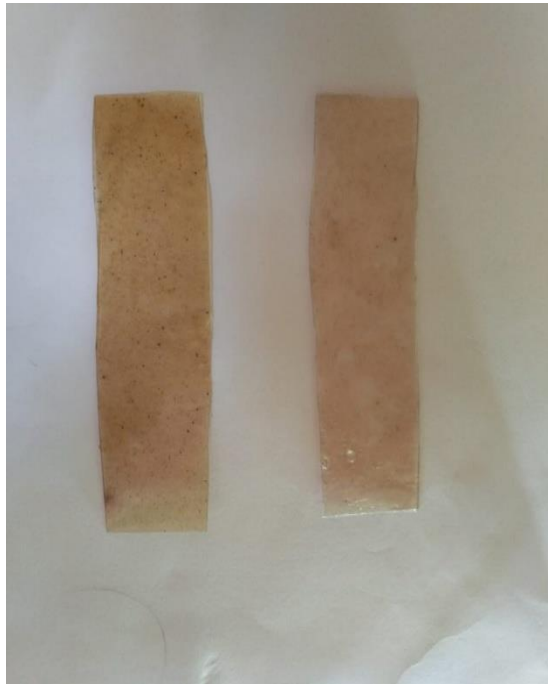
Gambar L.9 Spesimen uji bending
