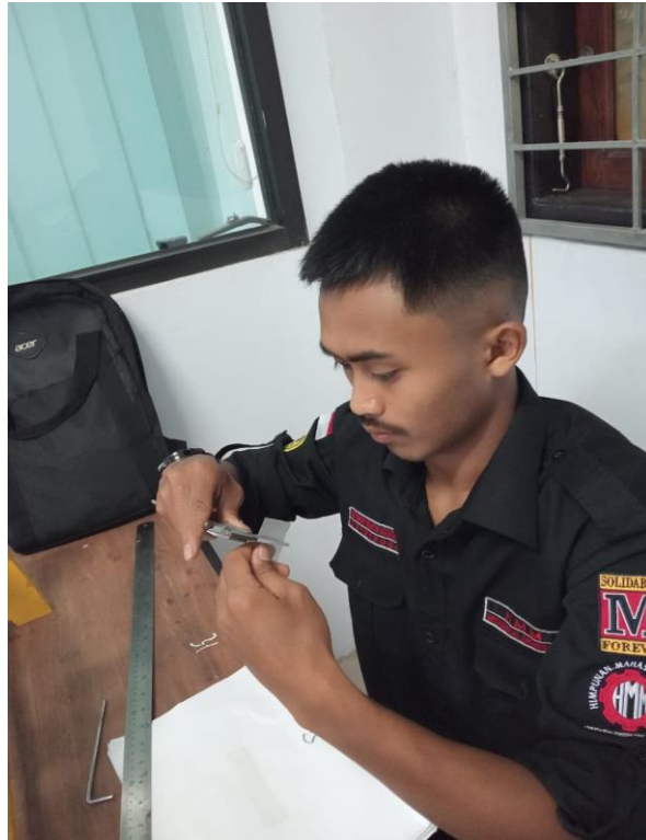
Gambar L.11 Pengukuran tebal spesimen
