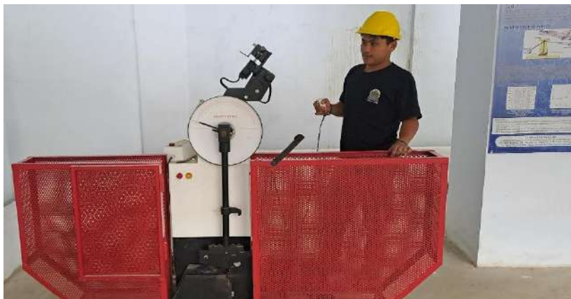
2.7 Proses pengujian impak
