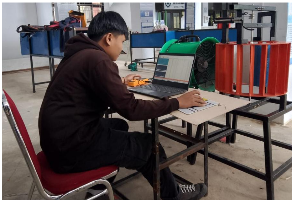
Gambar L.20 Proses Pengukuran Kecepatan Angin Menggunakan Anemometer Data Logger
