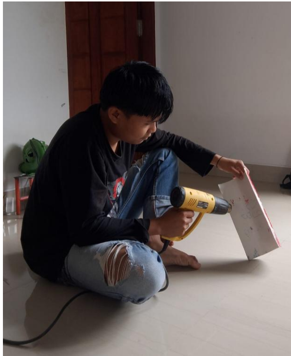
Gambar L.12 Proses Pembentukan Sudu Menggunakan Heat Gun
