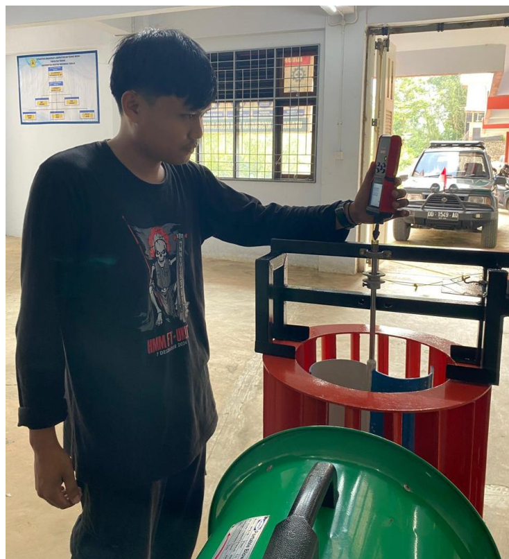
Gambar L.22 Proses Pengukuran Kecepatan Putaran Dengan Tachometer
