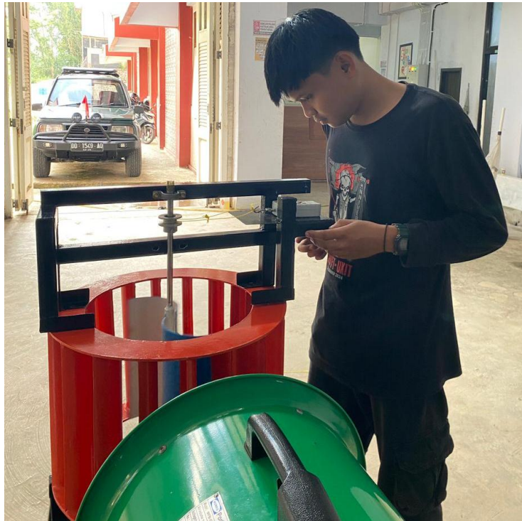
Gambar L.21 Proses Pengukuran Pembebanan Menggunakan Torsi Meter
