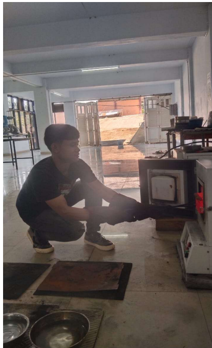
Gambar L.12 Pengangkatan Spesimen dari dalam Tungku Setelah di Carburizing Selama 30, 60, 90, 120 dan 150 Menit
