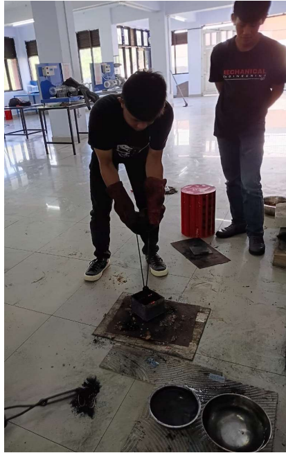
Gambar L.13 Proses Pencelupan Spesimen ke Media Pendingin Air
