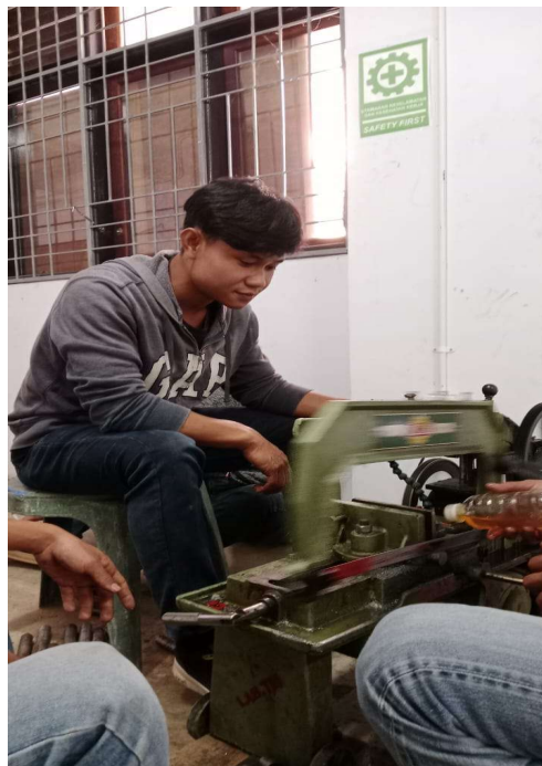
Gambar L.2 Proses Pemotongan Baja ST 37 dengan Ukuran 1cm
