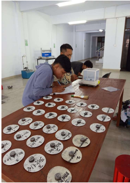
Gambar L.17 Penimbangan Spesimen Setelah Proses Uji Keausan
