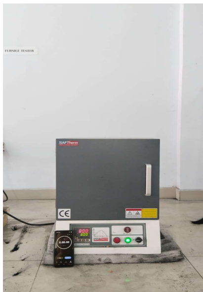
Gambar L.10 Memulai Proses Pack Carburizing dengan Temperatur 800°C dan Waktu Penahanan 120 Menit
