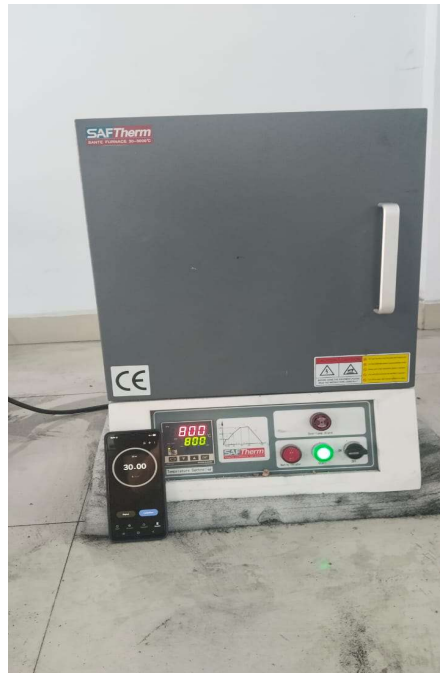
Gambar L.7 Memulai Proses Pack Carburizing dengan Temperatur 800°C dan Waktu Penahanan 30 Menit
