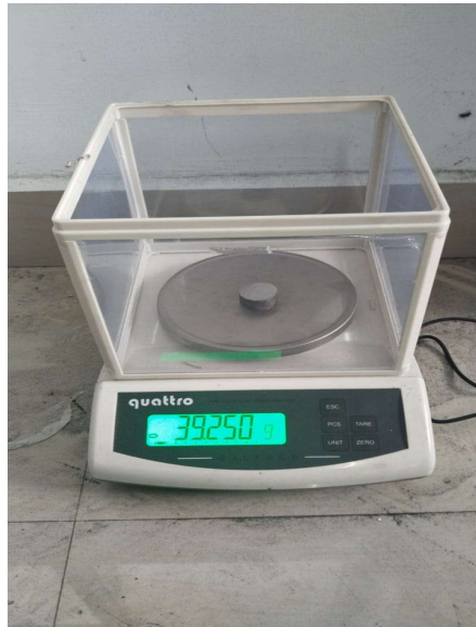
Gambar L.15 Penimbangan Berat Awal Spesimen Sebelum Uji Keausan
