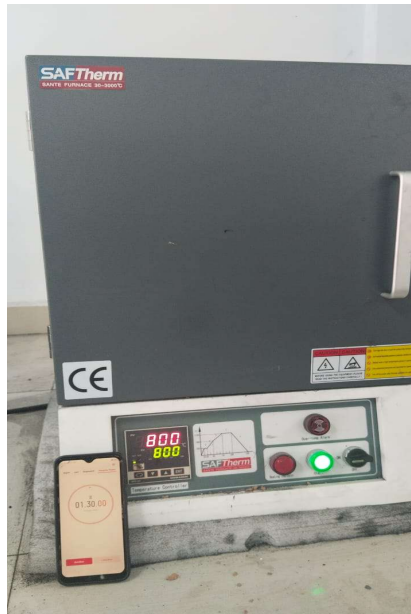
Gambar L.9 Memulai Proses Pack Carburizing dengan Temperatur 800°C dan Waktu Penahanan 90 Menit
