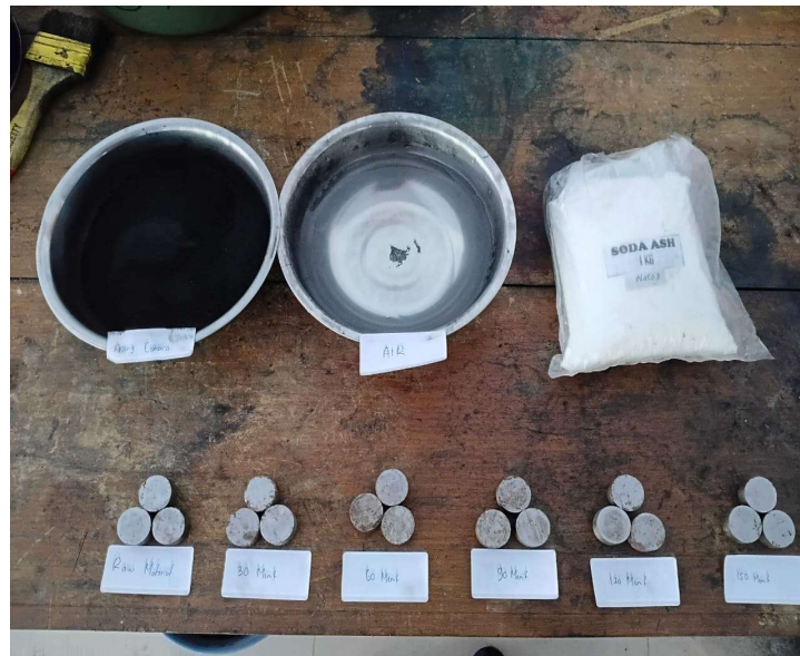
Gambar L.5 Pengumpulan Semua Bahan untuk Memulai Proses Carburizing
