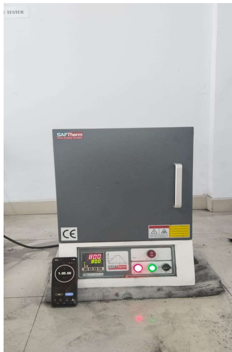
Gambar L.8 Memulai Proses Pack Carburizing dengan Temperatur 800°C dan Waktu Penahanan 60 Menit
