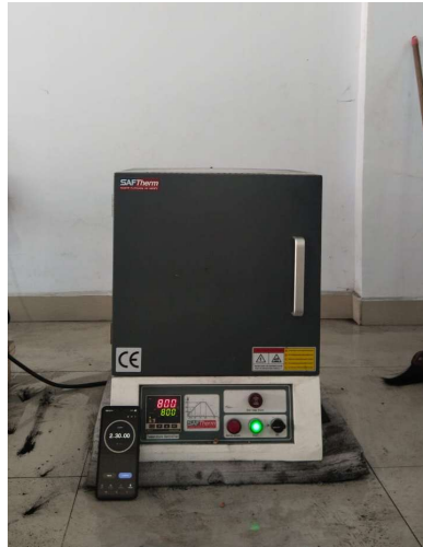
Gambar L.11 Memulai Proses Pack Carburizing dengan Temperatur 800°C dan Waktu Penahanan 150 Menit
