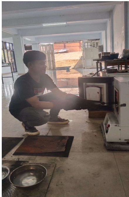
Gambar L.6 Proses Memasukkan Bahan ke dalam Tungku
