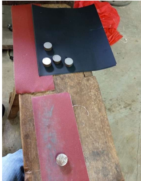
Gambar L.14 Pengamplasan Spesimen Sebelum Uji Keausan
