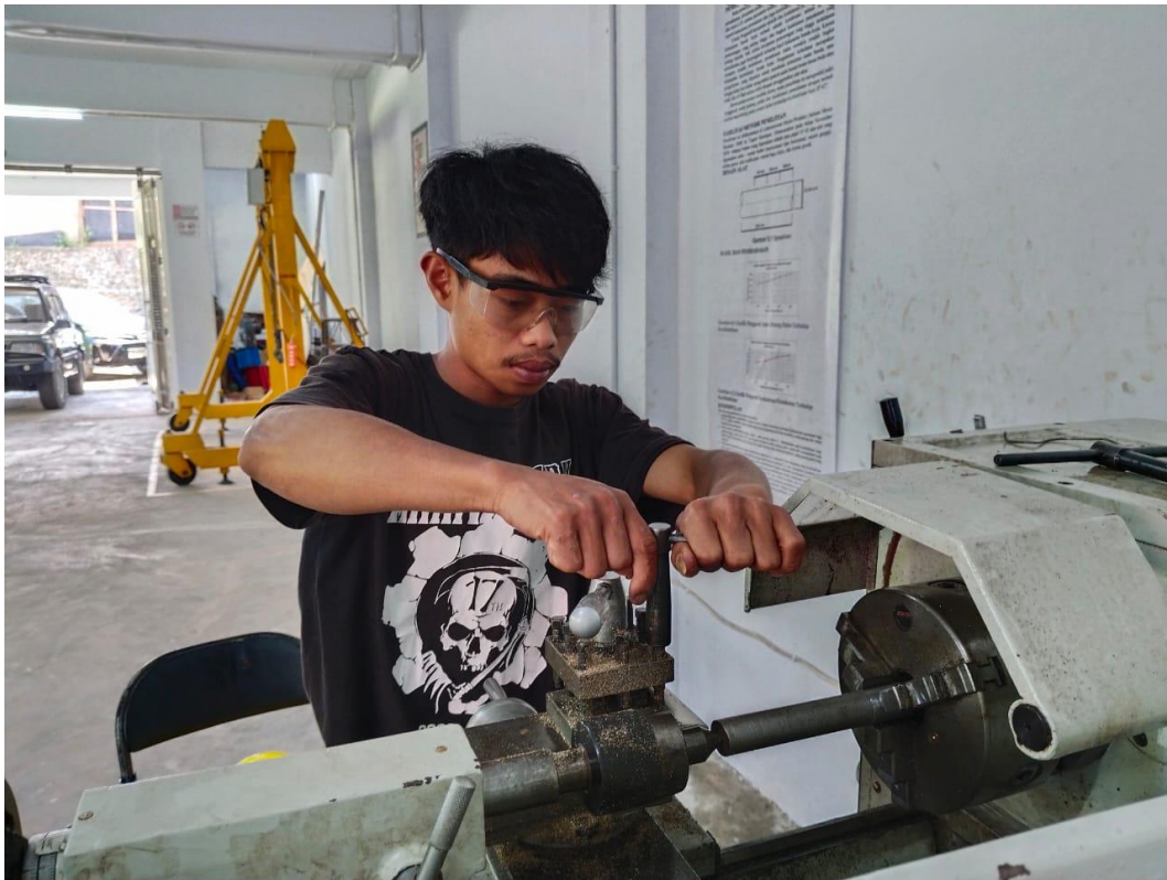
Gambar 5. Proses pemasangan pahat
