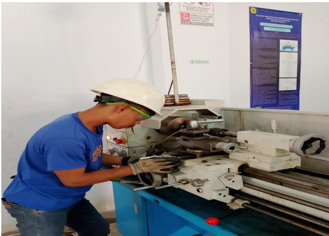
Gambar 6. Mengatur kedalaman potong
