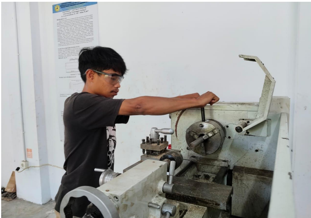
Gambar 4. Proses pemasangan spesimen pada cekam
