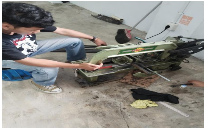
Gambar 1. Proses pemotongan spesimen baja S45C
