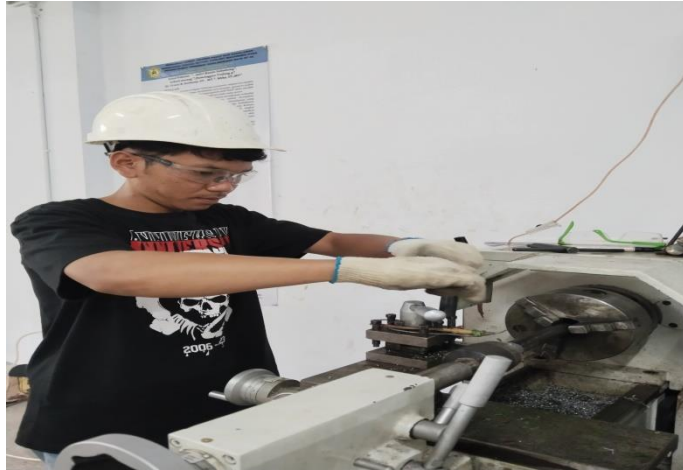
Gambar 4. Pemasangan pahat HSS bohler M35
