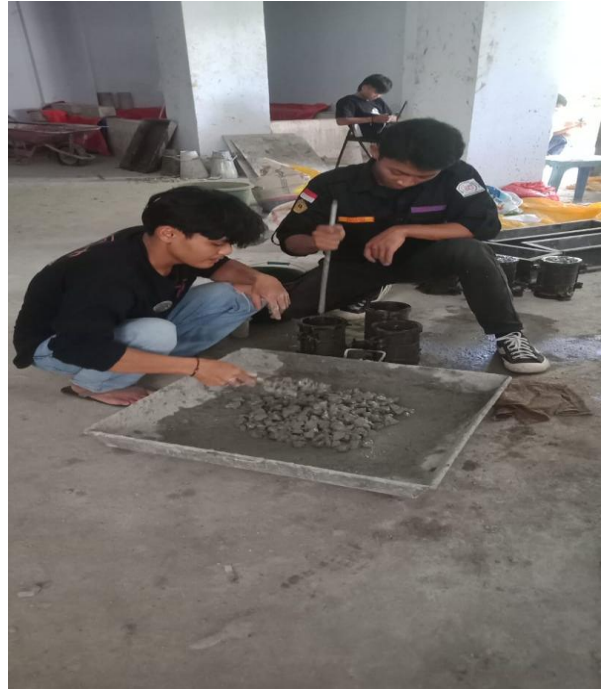
Pencampuran Material dan Cetak Sampel
