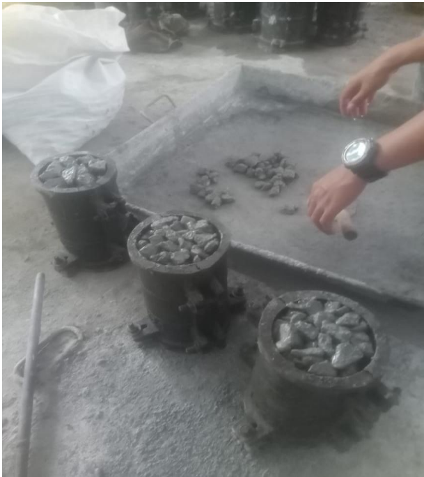
Pencampuran Material dan Cetak Sampel
