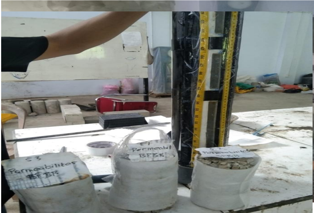
Timbang Sampel kering Uji permeabilitas
