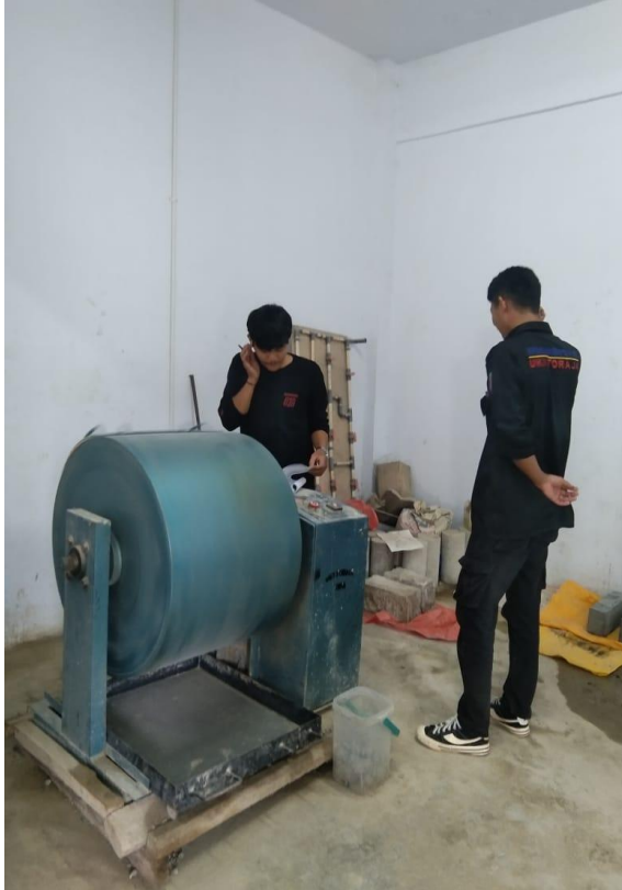
Uji Keausan (Abrasi) Agregat Kasar
