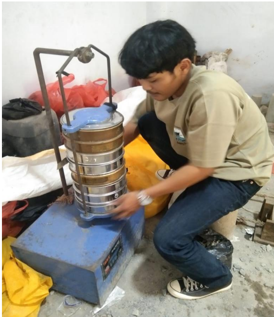
Analisi Saringan Agregat
