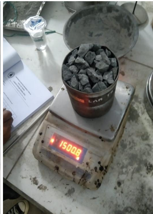
Pencucian dan Penimbangan Agregat Kasar (uji kadar air)
