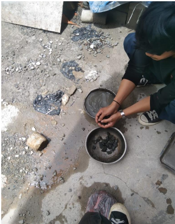
Pencucian dan Penimbangan Agregat Kasar (uji kadar air)
