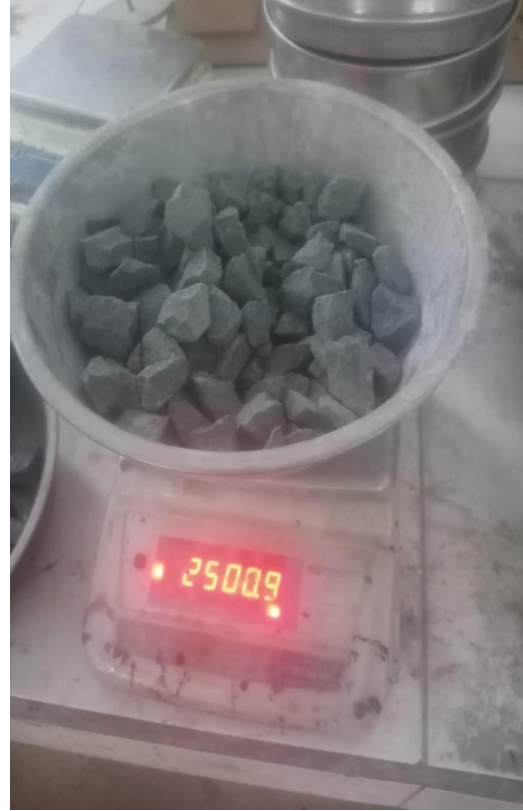
Uji Keausan (Abrasi) Agregat Kasar
