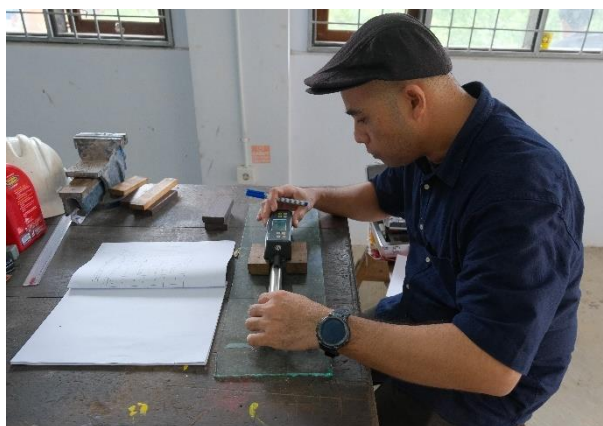
Gambar L. 3 Proses Pengukuran Kekasaran
