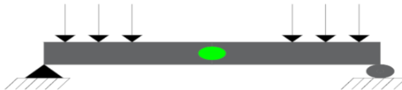
Gambar 2. 5 Balok Bentang Tersuspensi
