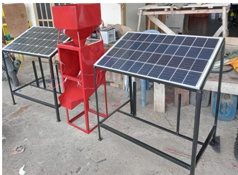
Gambar I-8 Proses Penyelsaian Alat Pembersih Gabah dan Meja Panel Surya
