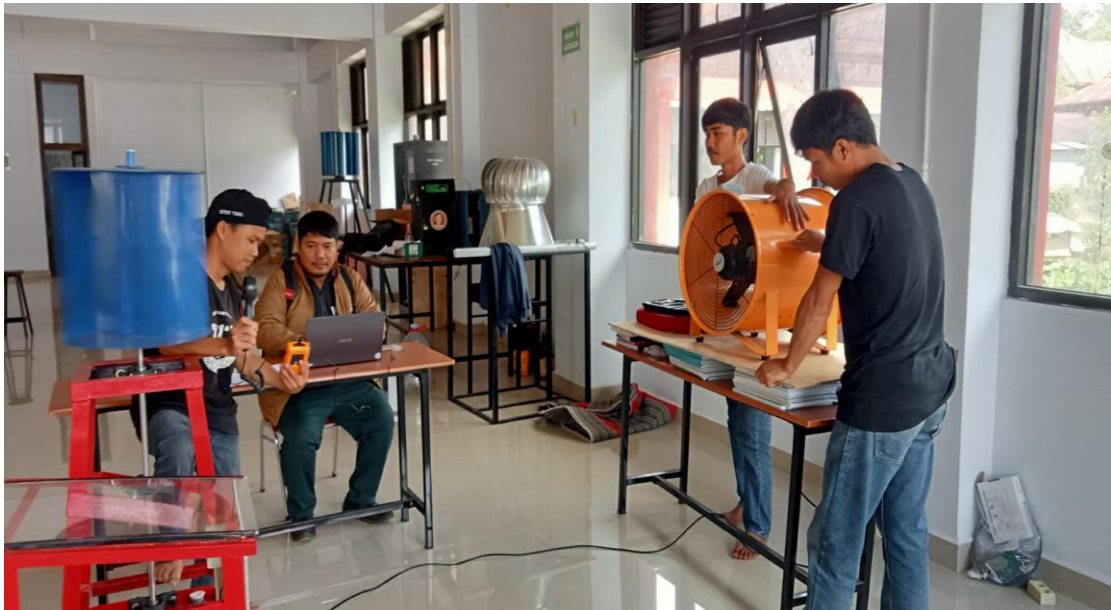
Gambar L-1.1 proses pengambilan data kecepatan angin menggunakan data logger
