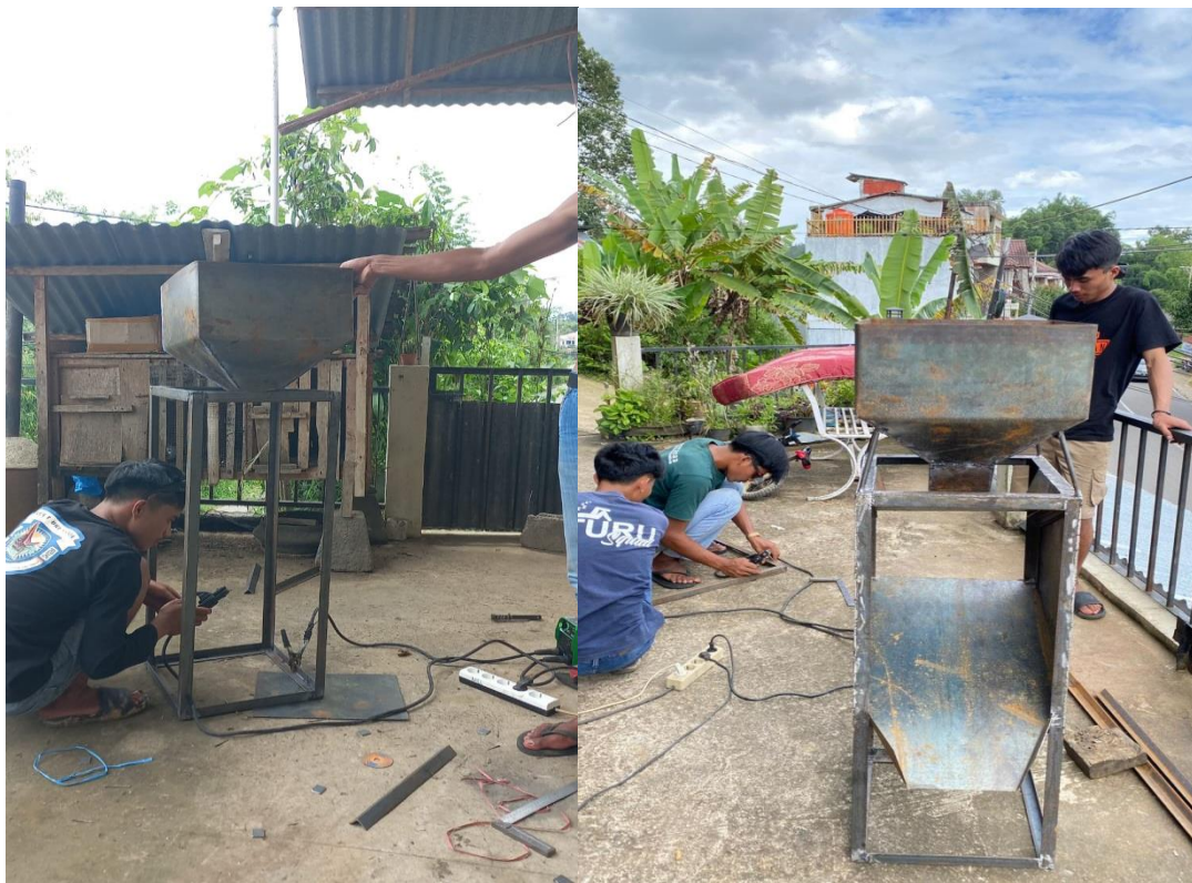
Gambar L-5 Proses Perancangan Pembersih Gabah
