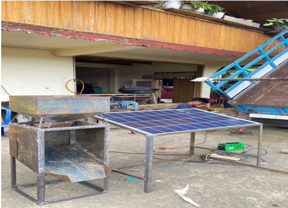
Gambar L-6 Perancangan Meja Panel Surya
