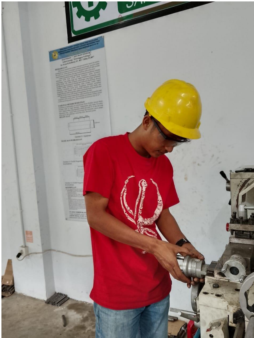
Gambar L. 7 mengkalibrasikan kedalaman potong
