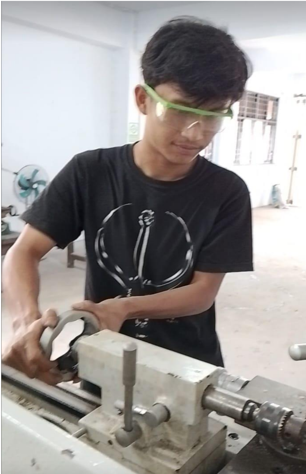
Gambar L. 2 melakukan senter bor kesetiap spesimen
