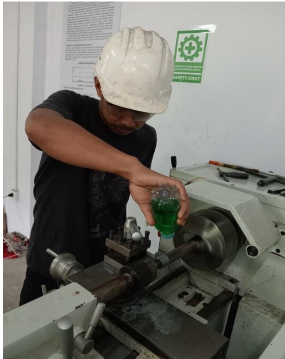
L4. Foto proses pembubutan specimen baja ST 41
