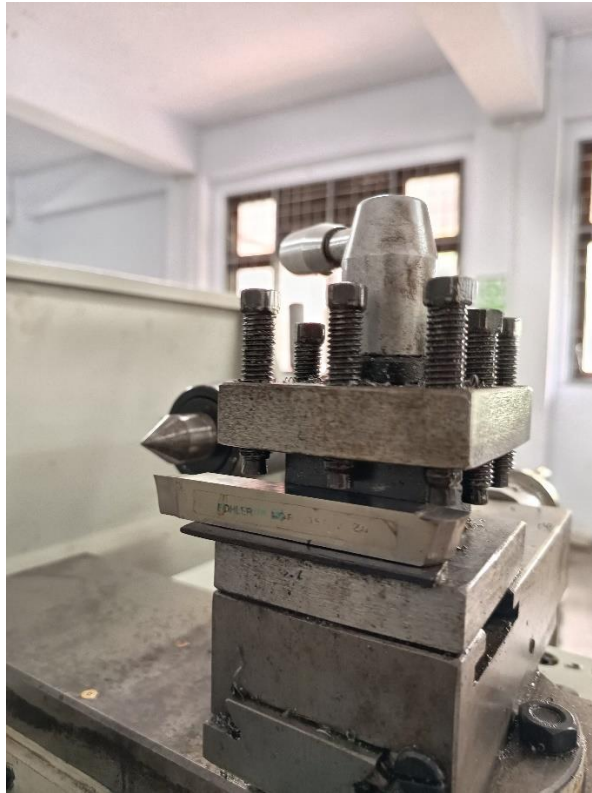
L3. Proses pemasangan pahat
