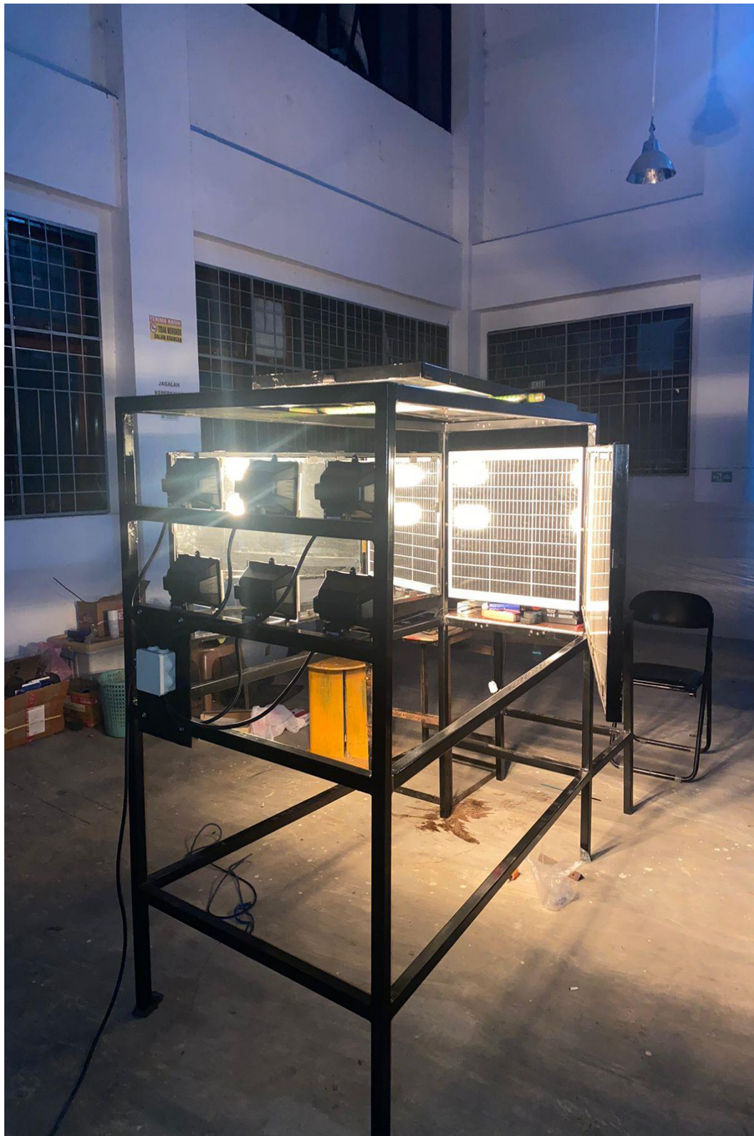
Gambar L-. 9 Instalasi solar cell 4 cermin reflektor tampak belakang
