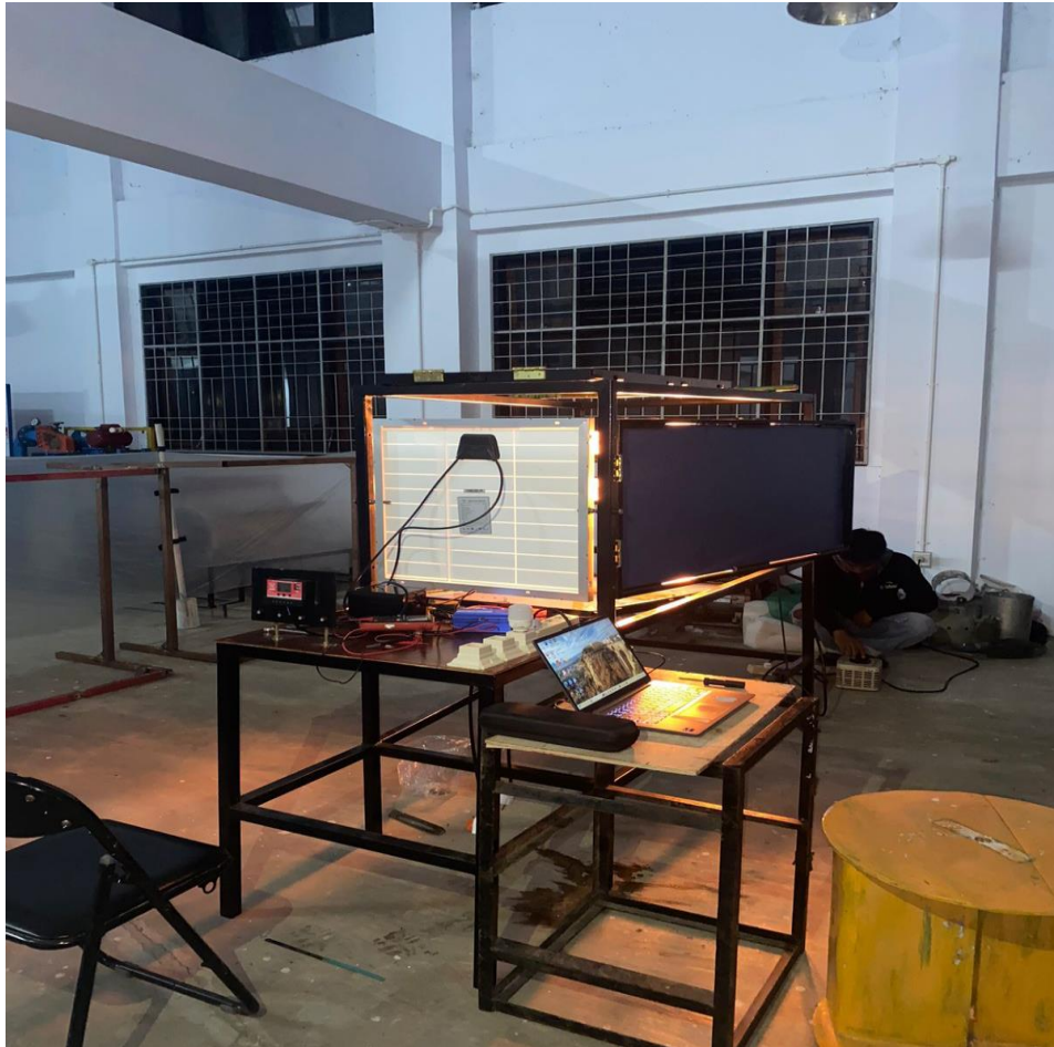
Gambar L-. 8 Instalasi solar cell 4 cermin reflektor tampak depan
