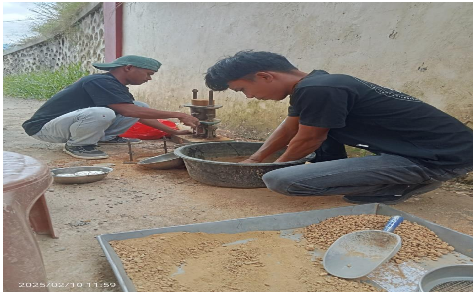
Pengujian Kompaksi/Pemadatan Tanah untuk mengetahui hubungan kepadatan tanah dan kadar air
