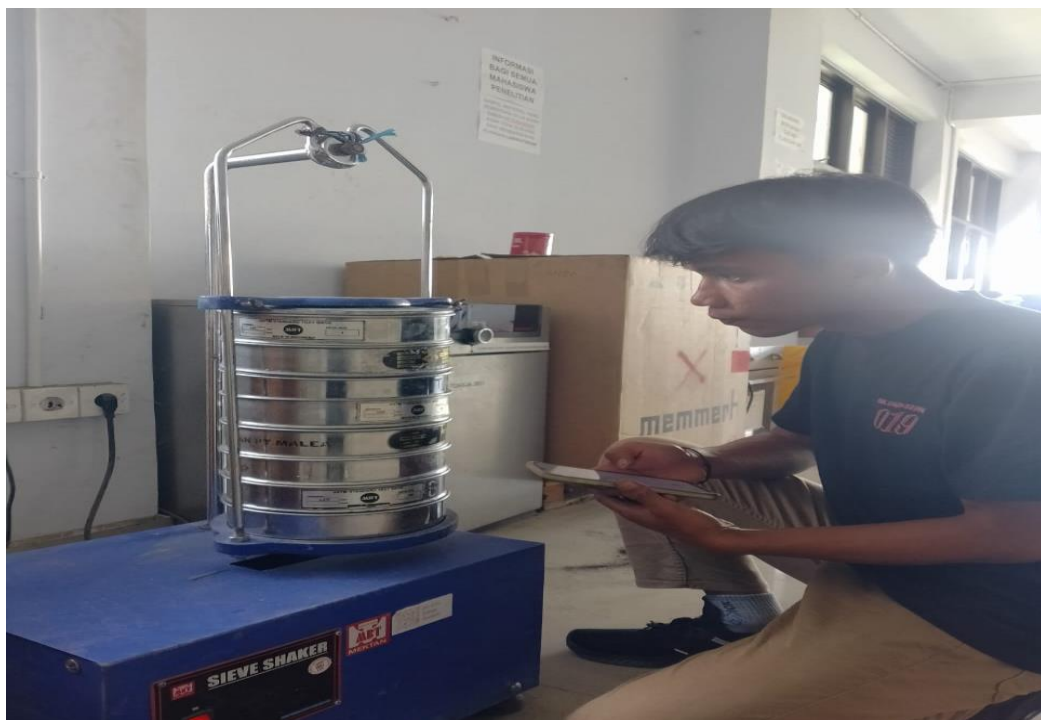
Pengujian Analisa Saringan untuk mengetahui ukuran butir dan susunan butiran(gradasi) yang tertahan saringan No.200
