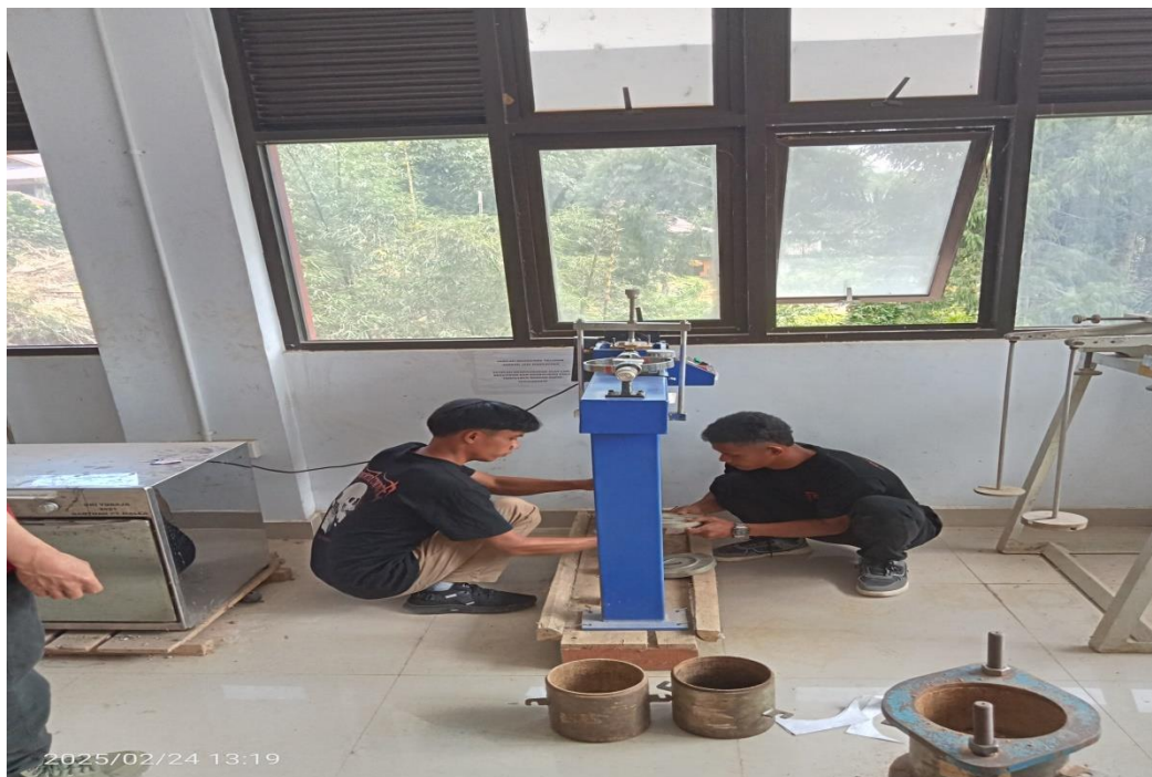
Pengujian Kuat Geser Langsung untuk mendapatkan sudut geser dalam dan kohesi
