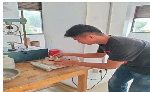
Memanaskan piknometer di hot plate
