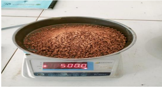
Tanah kering yang lolos saringan No.4
