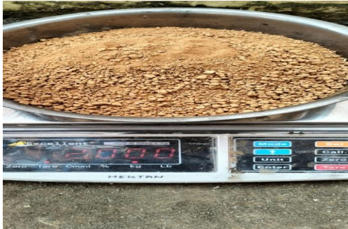
Tanah yang lolos saringan No.4 (2000 gr)
