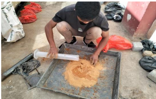
Mencampur tanah dengan air
