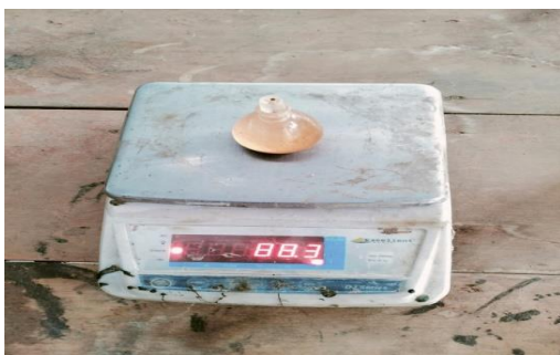
Berat air, piknometer dan tanah
