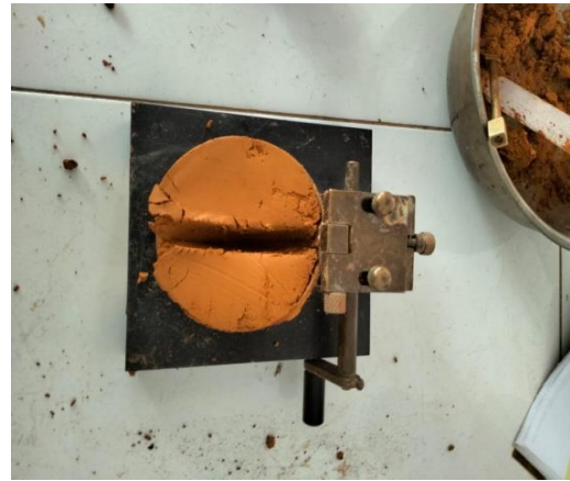
Benda uji dan grooving tool
