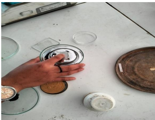
Benda uji, mangkok shrinkage, Dan air raksa
