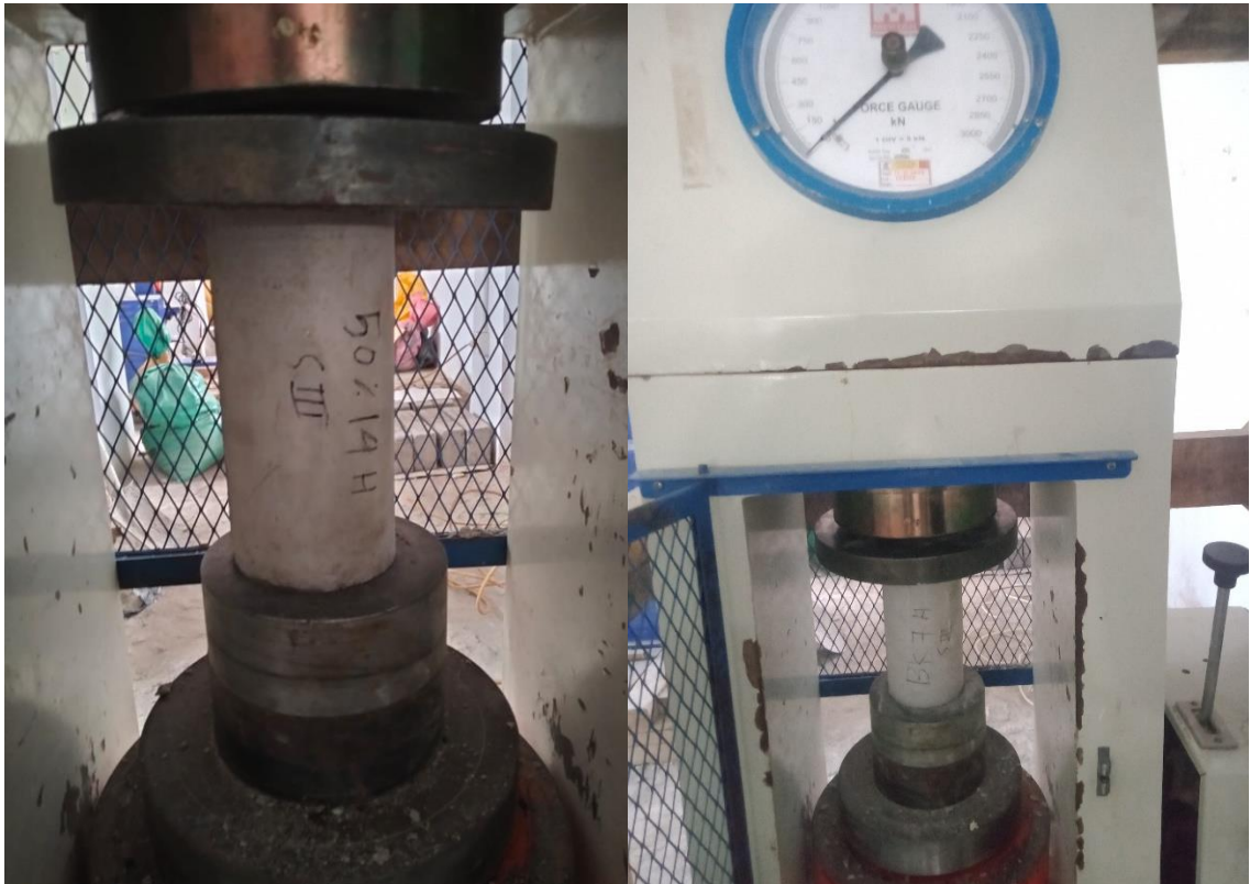
Pengujian Kuat Tekan Beton pada Sampel
